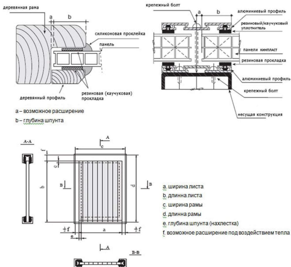
Рисунок 15. Схематический рисунок углубления и возможного расширения.
