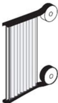
Рисунок 17с. Установка герметизирующей ленты на конце панели
